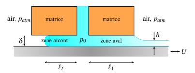
On suppose que l'écoulement est stationnaire et pleinement développé. La peinture est assimilée à un fluide Newtonien de viscosité dynamique  $\mu$  constante. La compressibilité du fluide et la tension superficielle sont négligées. On suppose connues et constantes les valeurs des paramètres (strictement positifs) U,  $p_0$ ,  $\delta$  et  $\ell_1$ .
