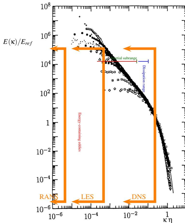
Dans l'approche DNS (*Direct Numerical Simulation*), toutes les échelles du mouvement sont explicitement décrites par le modèle numérique. Aucune hypothèse simplificatrice ne doit donc être introduite mais le coût numérique est très important car la résolution spatiale et temporelle doit être suffisante pour capturer aussi bien les structures les plus grandes, à l'échelle du problème considéré, que les structures turbulentes les plus fines, caractérisées par la microéchelle de Kolmogorov
