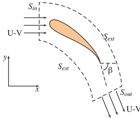
Avec les hypothèses faites ici (air incompressible, non-visqueux et régime stationnaire), Bernoulli peut être appliqué sur une ligne de courant passant par l'entrée et la sortie du volume de contrôle. Cela donne (gravité négligée),
