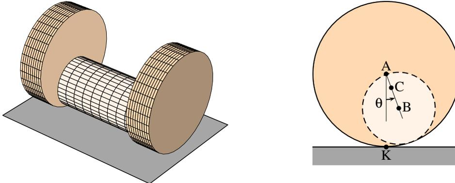
L'ensemble est étudié sous l'hypothèse du mouvement plan en assimilant l'élément à un solide cylindrique de centre  $A$  et de rayon  $a$  dont le centre d'inertie  $C$  est situé à une distance  $d = \|\mathbf{AC}\| < a/2$  de  $A$ . On note  $J_C$  le moment central d'inertie du solide pour la rotation autour d'un axe perpendiculaire au plan du mouvement et  $B$  la trace dans le plan du mouvement de l'axe de symétrie du cylindre de rayon  $a/2$ .
