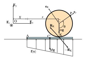
i. Le livre est en mouvement plan (3 ddl maximum) et glisse sans rotation (1 liaison) en restant en contact avec le plan horizontal (1 liaison). Il possède donc un seul degré de liberté qui peut être
