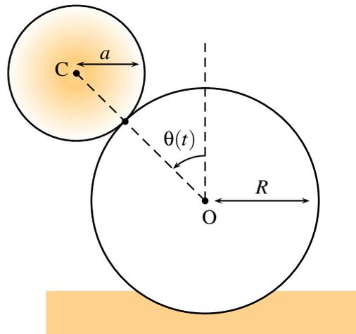
On étudie le mouvement plan d'un crayon, assimilé à un cylindre de rayon  $a$ , qui roule sans glisser sur la surface extérieure d'un cylindre fixe de rayon  $R$ . Le crayon, de masse  $m$ , est non homogène mais sa masse est répartie selon une symétrie de révolution. Les axes de symétrie de révolution du crayon et du cylindre fixe sont parallèles entre eux et perpendiculaires au plan du mouvement.
