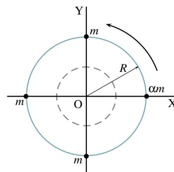
Pour mettre en oeuvre l'équilibrage de ce système, on peut placer des masses additionnelles sur un cercle de rayon  $R/2$ . Déterminez la masse  $\mu$  et la position sur le cercle de rayon  $R/2$  d'une telle masse additionnelle permettant de réaliser l'équilibrage statique et dynamique du système.
