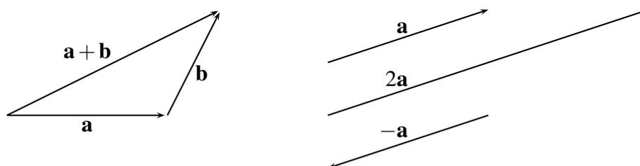
FIGURE 2.2: Addition de deux vecteurs et multiplication par un scalaire.
